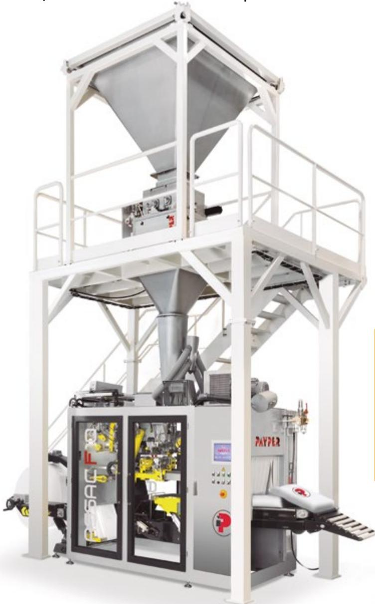
Dieses Konzept ist absolut zuverlässig aufgrund der Tatsache, dass während dem Ablauffunktionen der Sack jeder Zeit festgehalten ist und erst freigegeben werden, wenn der gesamte Prozess abgeschlossen ist.
