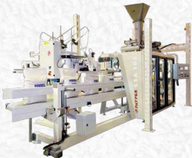
Aplicadores de sacos de boca abierta Open mouth bag stations
