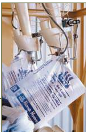
TAG Ensacadora manual para sacos de válvula TAG Manual filling for valve bags
