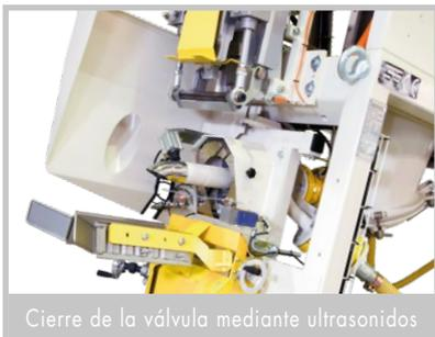
Cierre de la válvula mediante ultrasonidos
