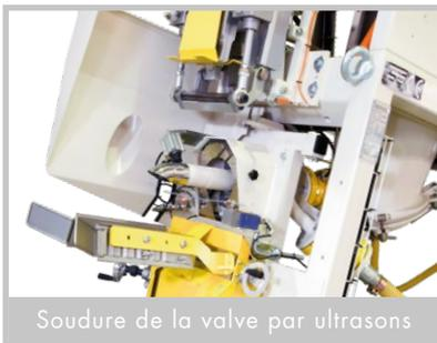
Soudure de la valve par ultrasons
