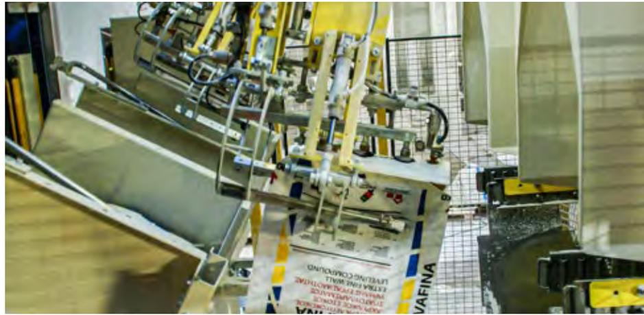
**Die zwei neuen automatischen Luftpacker mit Ventilverschlussystem**
