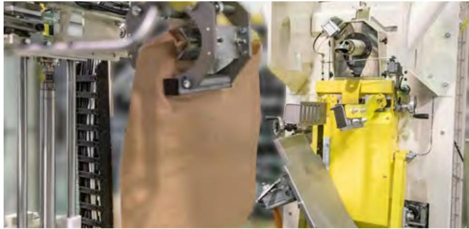
Jetzt haben sie ein ALL-IN-ONE mit einem Absackstutzen und integrierter Palettierung installiert. Die 25-kg-Säcke werden mit diesem Roboter, der auf einer sehr reduzierten Grundfläche (4 m x 6 m) installiert ist, gefüllt, versiegelt und palettiert. Der Bediener füllt das Leersackmagazin wieder auf und sammelt die beladenen Paletten für den Versand ein.
