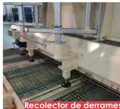
**Recolector de derrames para reciclar el material derramado**
