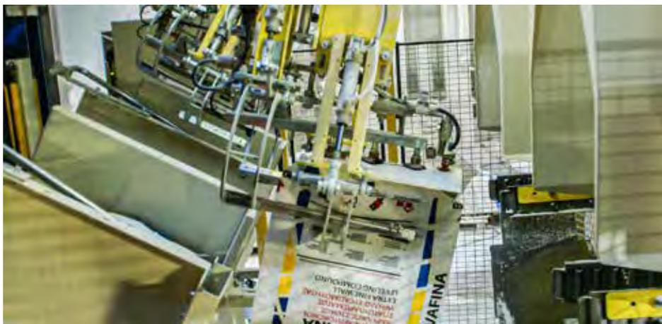
**Dos nuevas envasadoras neumáticas automáticas con sistema de sellado de válvula**
