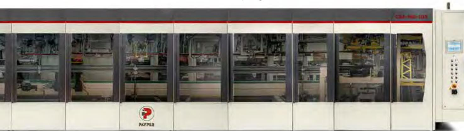
Un sistema de desaireación evacua el aire del saco antes del cierre final por soldadura. Opcionalmente hemos dejado una estación libre en el **CSA MD 105**. De forma que en una etapa posterior, podemos instalar una sonda con una doble función: extraer el aire del saco y llenarlo con un gas inerte.
