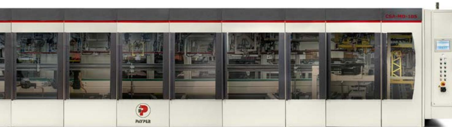
Un système de désaération évacue l'air du sac avant la fermeture finale par soudure. En option, nous avons laissé une station ouverte dans le système CSA MD 105. Ultérieurement, nous pourrions installer une sonde ayant une double fonction: elle vide le sac de l'air et elle peut le remplir d'un gaz inerte.
